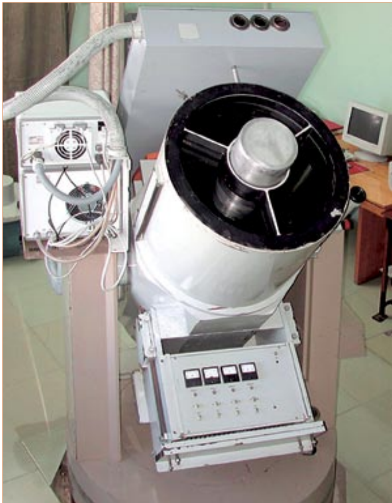
Рис. 15. Лидарная станция Теплоключенка (вверху) и лидарный комплекс (внизу).
